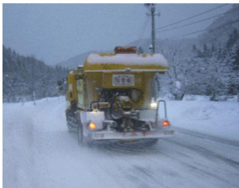
写真 4-1 凍結抑制剤散布状況
