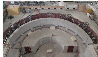
写真-1 覆工载荷実験
