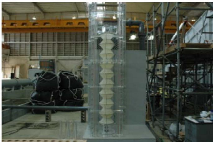
写真－2 柔構造模型
