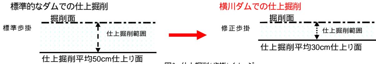
図2 仕上掘削(歩掛)イメージ
