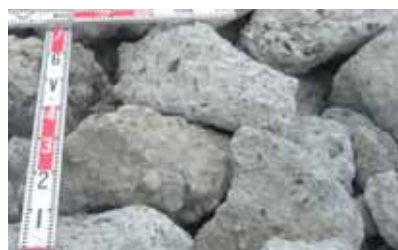
写-2 材料としてのコンクリート廃材
