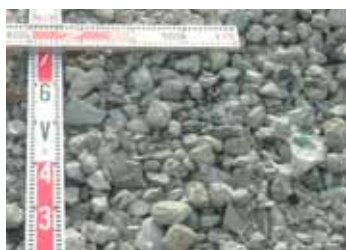
写-3 破碎後のコンクリート廃材
