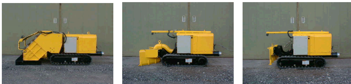
写真-2 試作機完成写真（左から：トレンチャ式、直接吸引式、排土板式）
