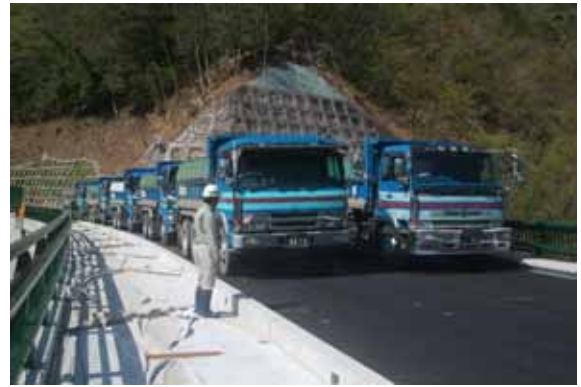
写真-3 静的載荷実験状況
