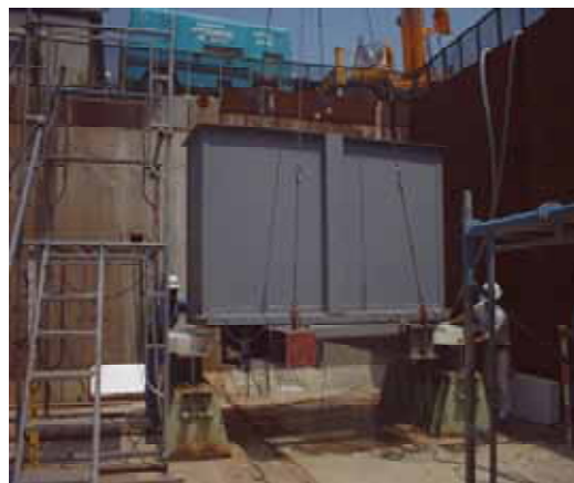
写真 - 5 水槽衝撃水圧載荷実験状況
