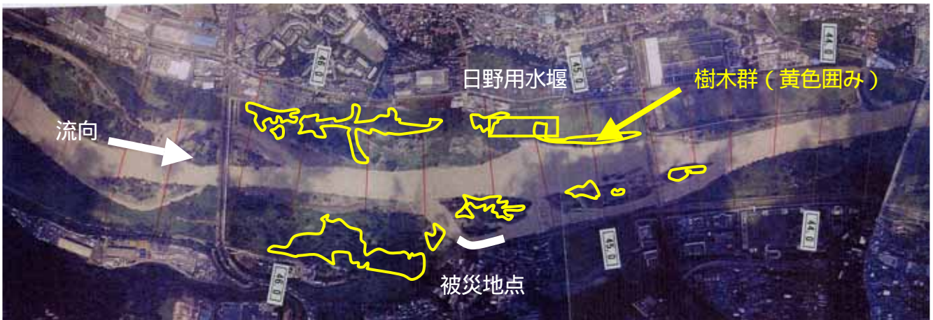
図4.2.1 河道内樹木群による河岸侵食の誘発（多摩川水系多摩川）
