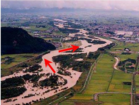
図1.2 樹木群による河岸侵食の誘発 (阿賀野川水系阿賀川)
