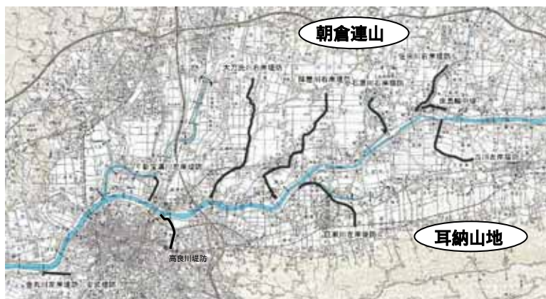
図3：山地に向かって垂直に伸びる控堤
