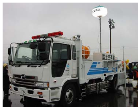
写真8 簡易照明装置
