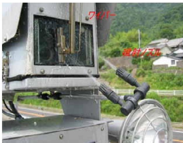
写真 - 8 水噴射状況
