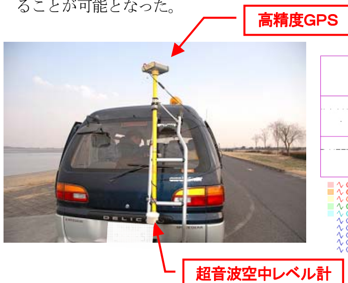
図-2 移動体による簡易水準測量
