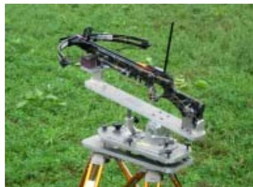
写真 - 2 クロスボーと制御架台
