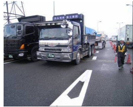
写真-3.1 載荷試験状況
