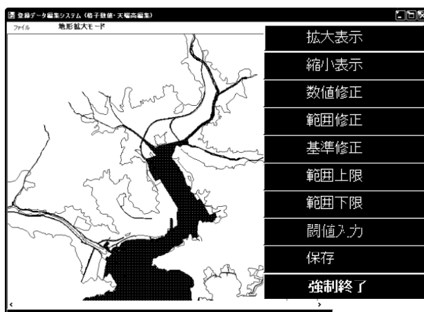
図-4 計算格子水深および構造物天端高の編集画面
