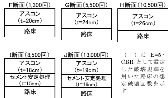
Fig.5 破壊基準検証断面
