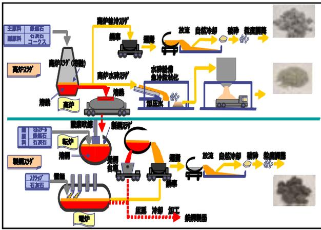
図 - 2 鉄鋼スラグの製造過程
