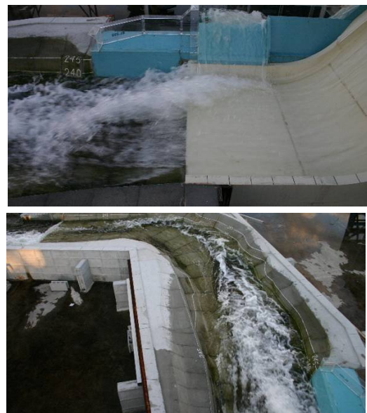
写真-15 既設・新設洪水吐き同時放流時の流況
