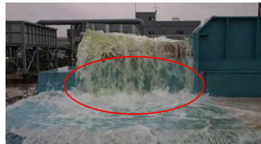
写真-8 エンドシル規模修正後の流況
