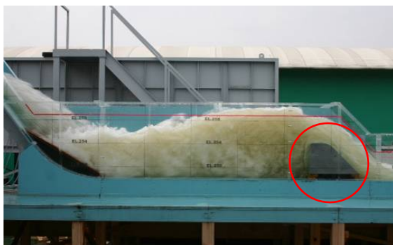
写真-7 副ダム嵩上げ後の流況
