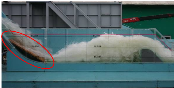
写真-6 傾斜ブロック設置後の流況
