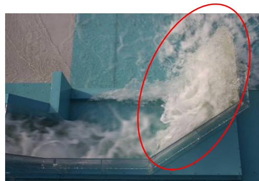
写真-5 河道越流方式河道越流部の流況
