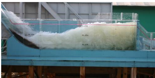
写真-10 横越流方式の流況 (切り欠き幅25m, 切り欠き高3.5m)
