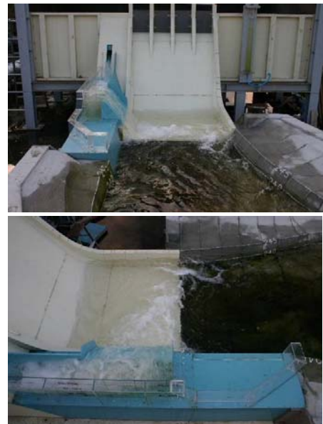
写真-14 新設洪水吐き単独放流時の流況
