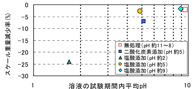
図-6 通水溶液の pH とスケール増減率の関係
