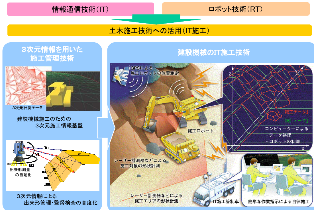
図 1 ロボット等による IT 施工システムの開発イメージ
