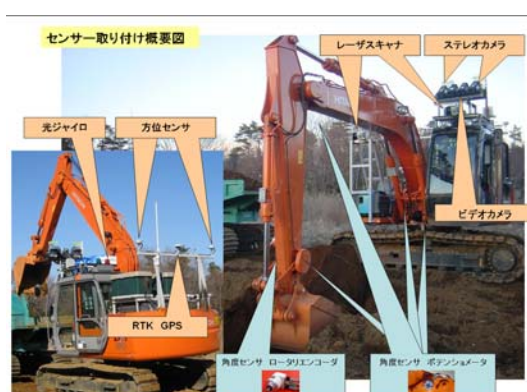
図5 油圧ショベル外観とセンサ取付図
