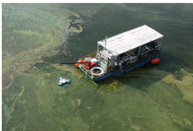
写真－２ アオコ回収船による作業状況
