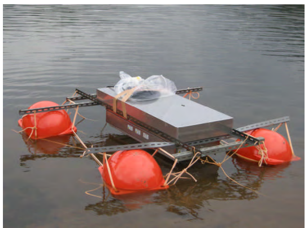
写真－４ 紫外線照射装置にフロートを装備した状態
