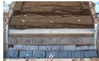
写真-4 試験体 No. 2-1 崩壊状況 (入力最大加速度 818gal)
