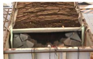
写真-3 試験体 No. 1-1 崩壊状況
