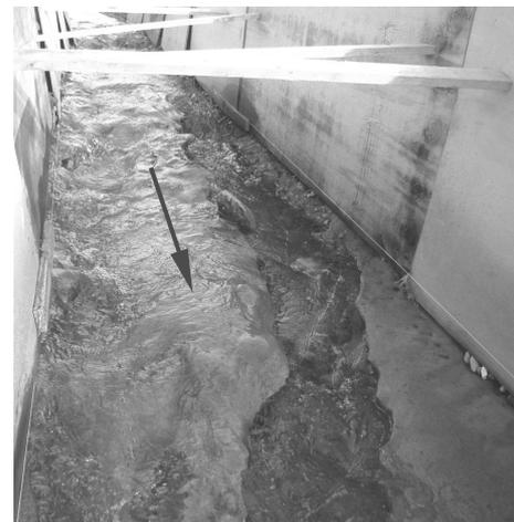
写真-5 実験終了後の水路（おう穴、みずみちの形成）
