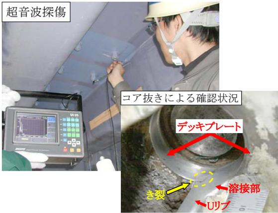
図-1.2 超音波(手動)探傷によるデッキ進展き裂の調査状況
