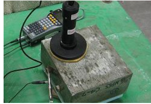
写真-2 乾湿繰り返し実験状況 写真-3 腐食速度測定状況
