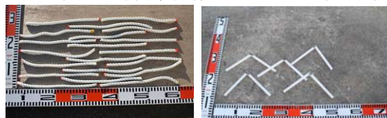
写真-3 投入流木の例（可撓性）：ナイロンロープ（左上），ヌンチャク型（右上）
