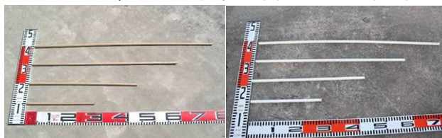
写真-2 投入流木の例（剛体）：全長8m, 13m, 18m, 23m 比重：0.7（左），1.14（右）
