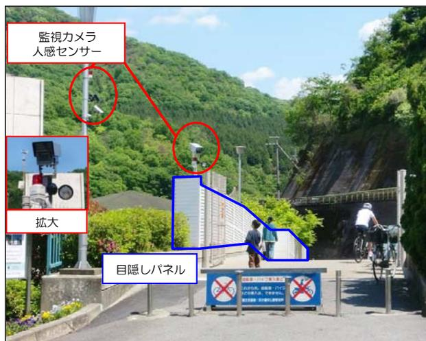
写真-1 入口ゾーンの整備（監視カメラ、目隠しパネル設置）
