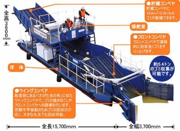
図-5 塵芥回収船(クリーンくわがた号)
