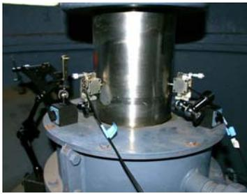
写真-1 渦電流式変位計
