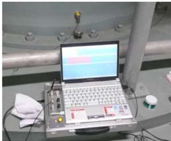
写真-2 超音波式振動計
