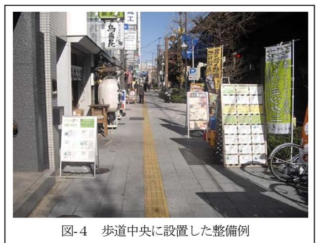
ガイドラインには「連続的かつ極力直線的に敷設するものとする」、「電柱などの道路占用物等の施設を避けるために急激に屈折させることのないよう、直線的に敷設することとする」と記載されている。しかし、実際の道路では工事区間単位で設置されているため、連続的に配置、マンホールを迂回して配置、歯抜け等当事務所管内でも様々な状況である。基本的な事項は決まっているものの細かな所で統一的な考え（基準）が定まっていなことが原因と考えられる。（図-5、-6、-8）
