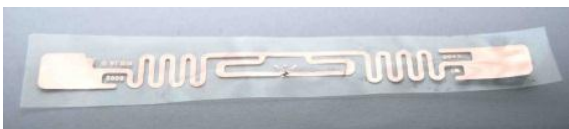
写真-3 UHF帯のICタグとアンテナ
