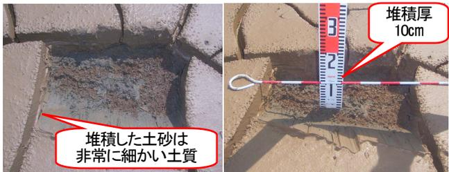
写真-7 堆積土砂の土質と堆積厚
