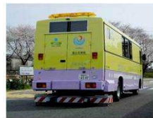
車道部: 空洞探査車
