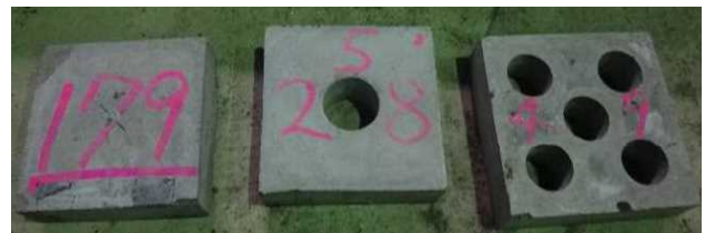
図-4 実験模型写真(被覆ブロック)
