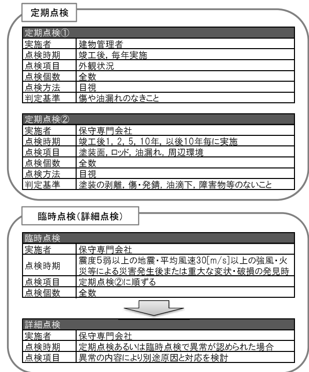
図-12 制振装置の点検フロー図 (例)
