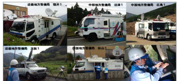
写真-13 各地方整備局の衛星通信車展開状況
