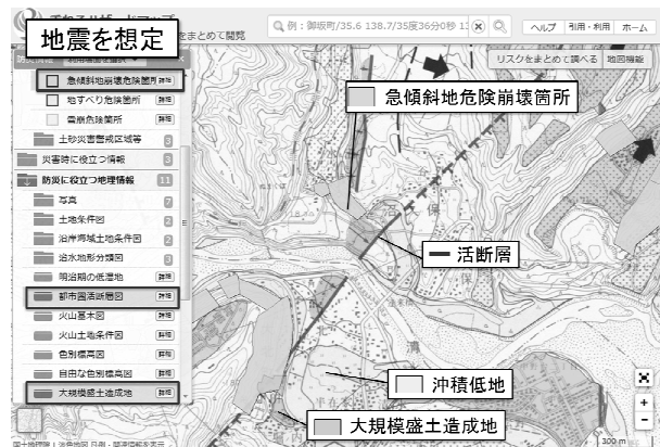
図-9 地震による災害を想定した例
