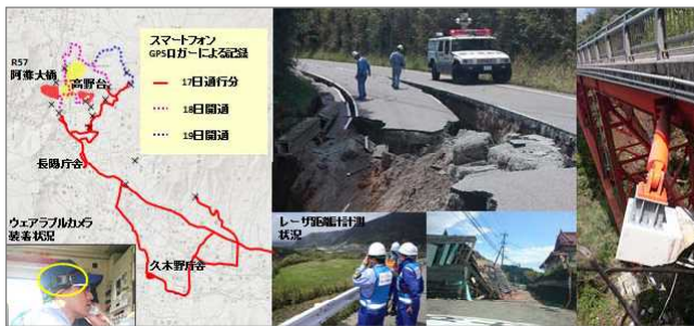
写真-10 GPSロガーによる走行軌跡及び道路被災状況
