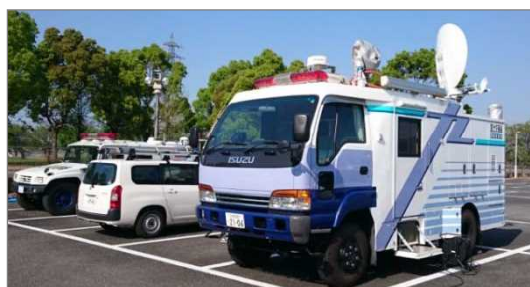
写真-2 グランメッセ熊本に展開した衛星通信車
