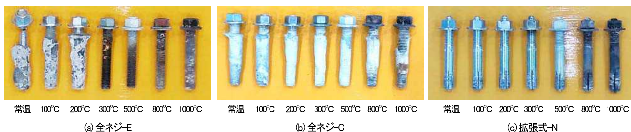
写真-3 加熱および引抜き試験後のアンカー
