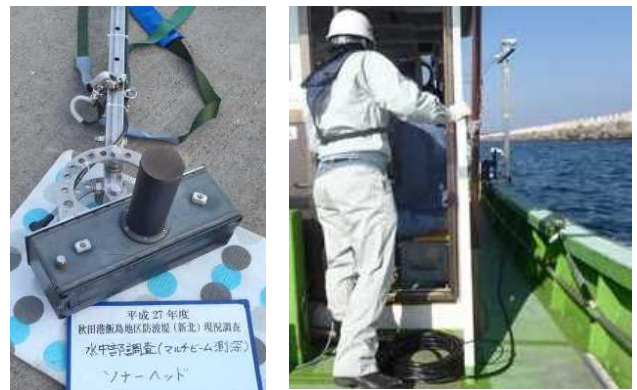
図-6 計測機器(ソナーヘッド)及び計測状況
