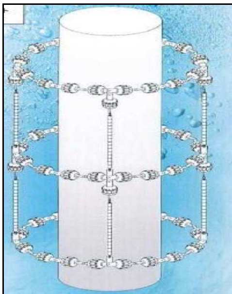
図-10 波力を利用した海生物除去装置 6)
