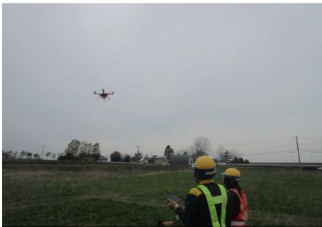
図-22 UAVによる起工測量
