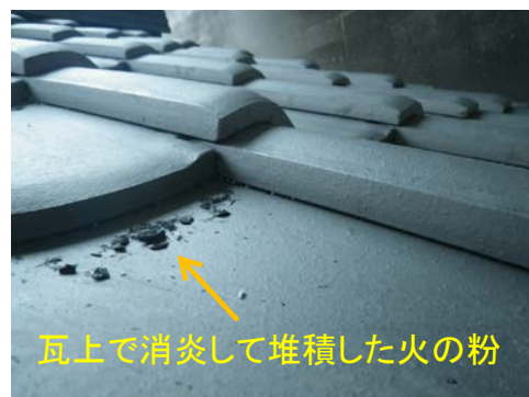
写真-8 瓦上部で消炎・堆積した火の粉（現代仕様）
