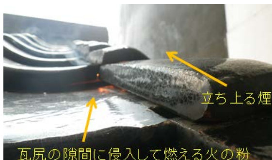
写真-4 風速 10m/s 実験時の瓦屋根上部
