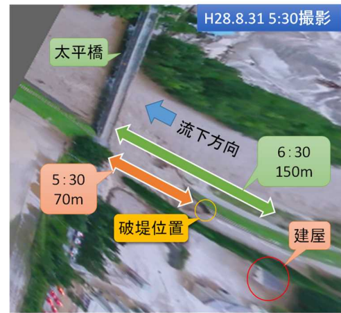
図-12 破堤長の変化
