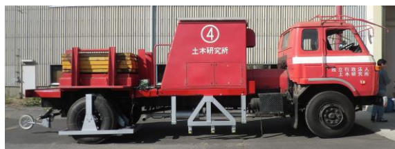
図-3 荷重車をベースにした試作機 (1号機)
