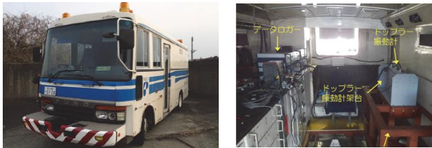
図-8 実道を走行可能な試作機 (2号機) (左: 車両外観, 右: 車両内部)
