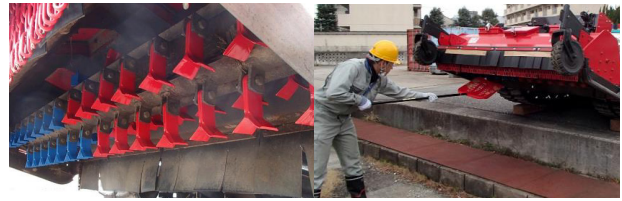
写真-7 比較試験状況(青:従来仕様、赤:幅広形状)
