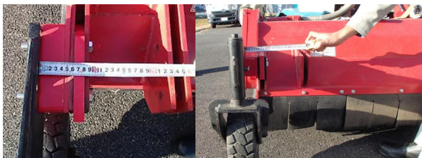
写真-12 変更後の車輪の取付位置
