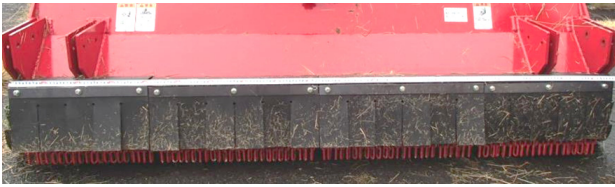
写真-14 チェーンとゴムカバーの2段配置状況
