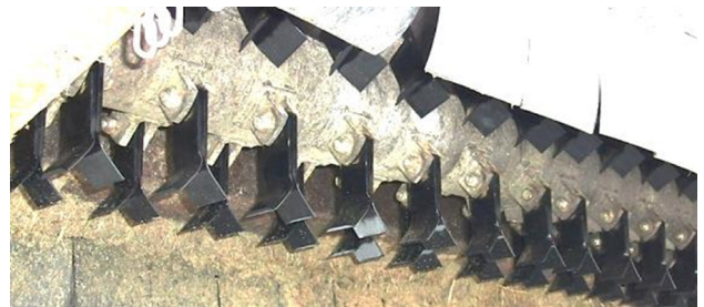
写真-4 モア内部の刈刃取付状況
