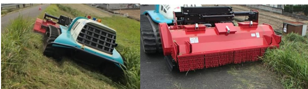
写真-16 スライド機能を使用した天端での除草状況
