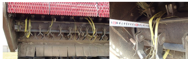
写真-9 点検窓を使用したつる草除去状況
