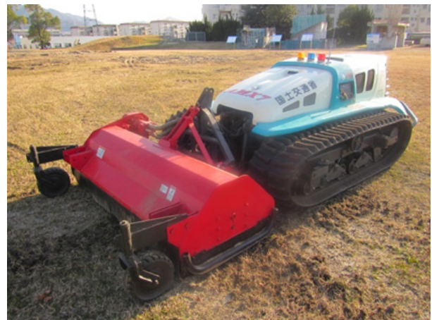
写真-1 大型遠隔操縦式草刈機
