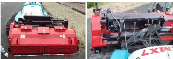
写真-15 試験機に導入したモア装置のスライド機能
