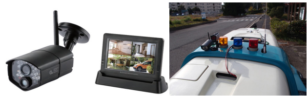
写真-15 ワイヤレスカメラのイメージと大型遠隔設置状況
