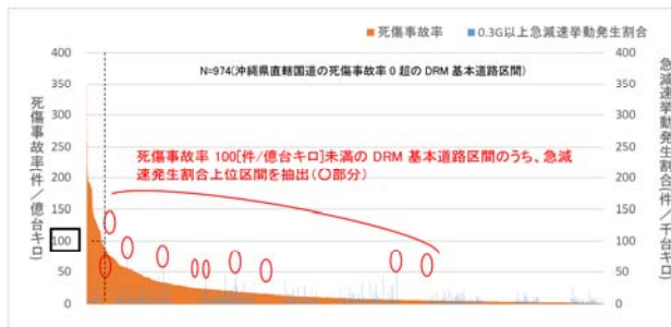
図-6 DRM区間別死傷事故率曲線図、危険箇所抽出
