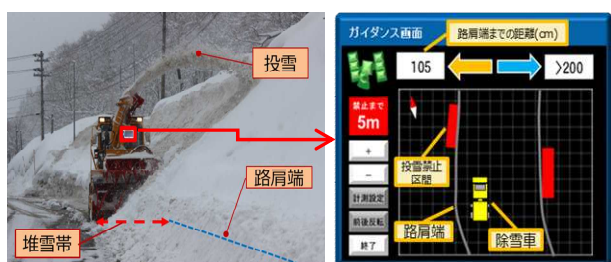
図-2 ロータリ除雪ガイダンスの概要
