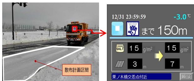
図-1 散布ガイダンスの概要
