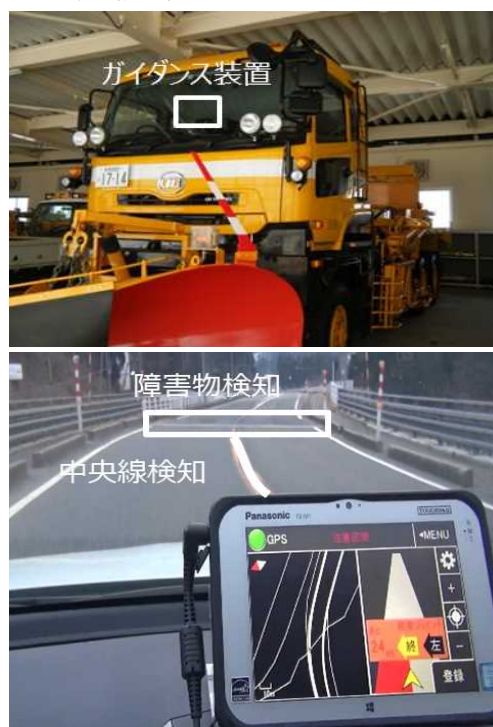
写真-2 一次除雪機械の作業ガイダンス装置
