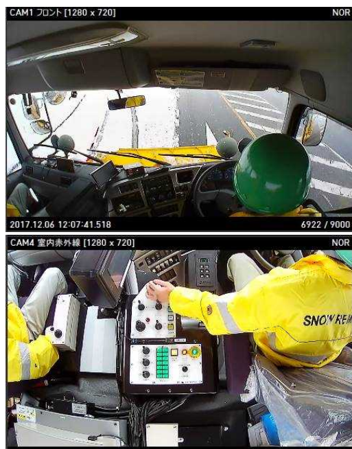
写真-4 作業装置操作状況録画
