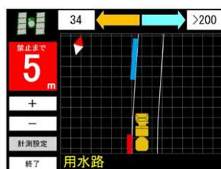
図-6 改良前 ロータリ 除雪ガイダンス画面
