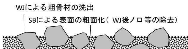
図-8 W.J. + S.B. による表面処理
