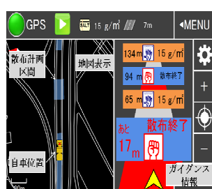
図-5 改良後 散布 ガイダンス画面
