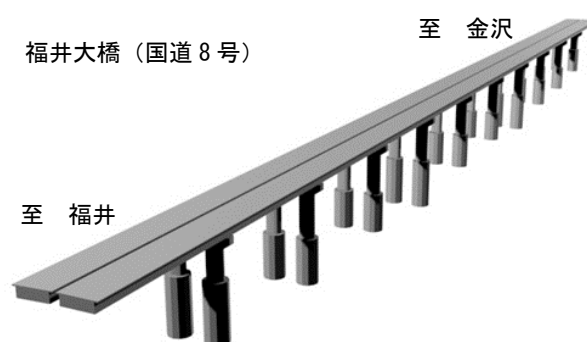
図-12 LOD200で3次元モデリングした橋梁
