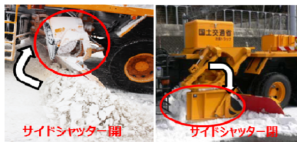
写真-5 サイドシャッターの動作状況
