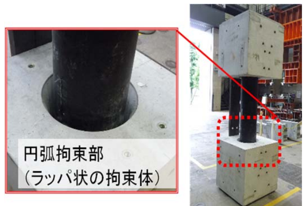
写真-3 円弧拘束型RC製制震装置の外観
