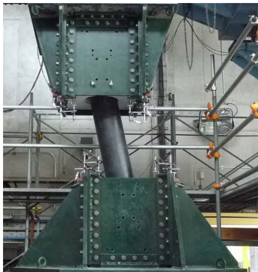
写真-5 载荷状況 (140mm変形時)
