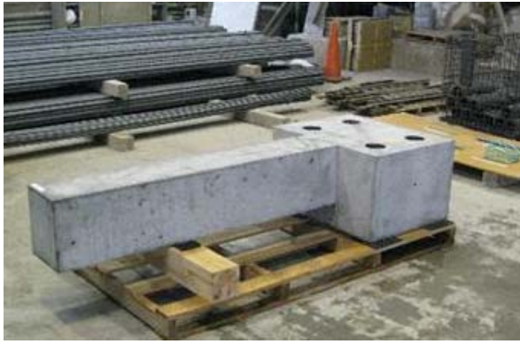
写真-2 ECC製制震装置（本体）の外観
