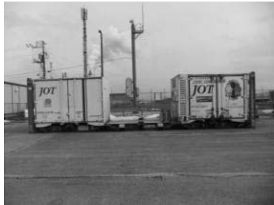
図-12 フラットラックコンテナへの12ftコンテナ設置状況
