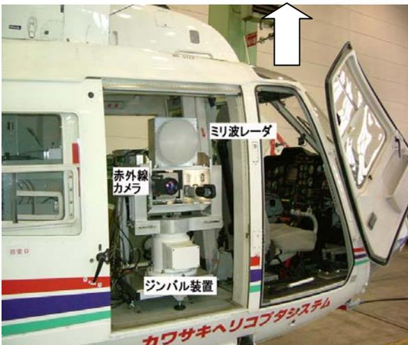
試作した障害物探知システムのセンサ部
