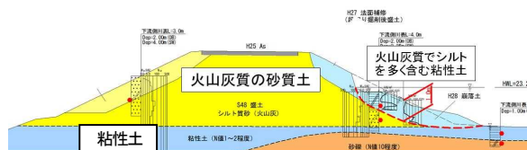
図-1 被災を受けた堤防の土質
