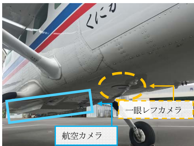
写真-1 測量用航空機底面に取り付けられた 一眼レフカメラ取付場所（点線部）と 航空カメラ取付場所（実線部）
