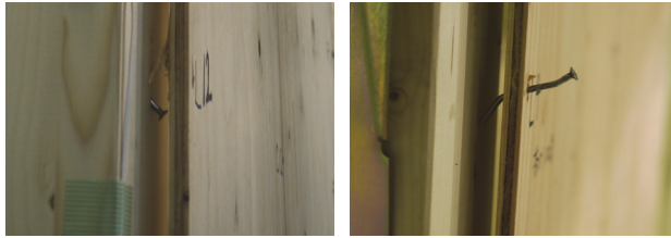
図-6 合板タイプにおける釘の破断モード
