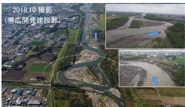
写真-1 十勝川 KP63 付近 (2018年出水で側岸侵食発生箇所)
