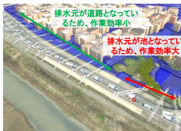
図-4 排水ポンプ車配置可能箇所の分類イメージ
