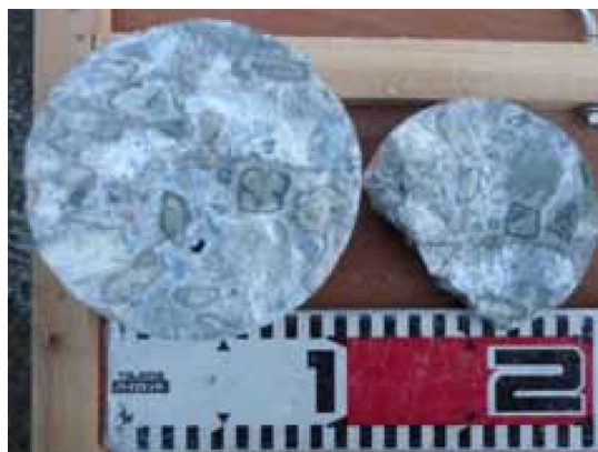
写真-3 アルカリシリカゲルの反応リム（状態③）
