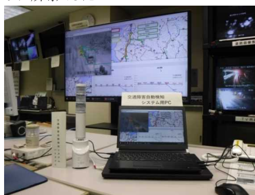
写真-9 AIカメラを用いたCCTVカメラの監視
