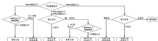
図-3 断面修復施工方法フロー
