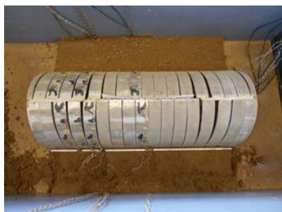
写真-11 CASE-1 加振後の状況
