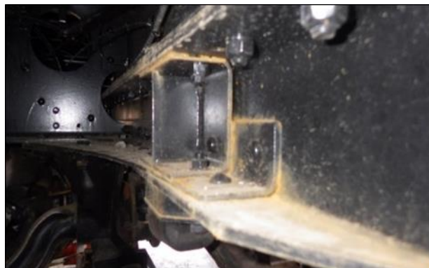
図-10 塗料B 除雪専用車シャシフレーム内側状況
