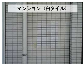
写真-5 パネル設置後の撮影画像の例（カメラ1，撮影距離2000mm，ひび割れ幅0mm）
