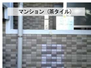
写真-5 パネル設置後の撮影画像の例（カメラ1，撮影距離2000mm，ひび割れ幅0mm）
