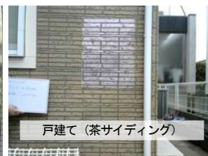
写真-5 パネル設置後の撮影画像の例（カメラ1，撮影距離2000mm，ひび割れ幅0mm）
