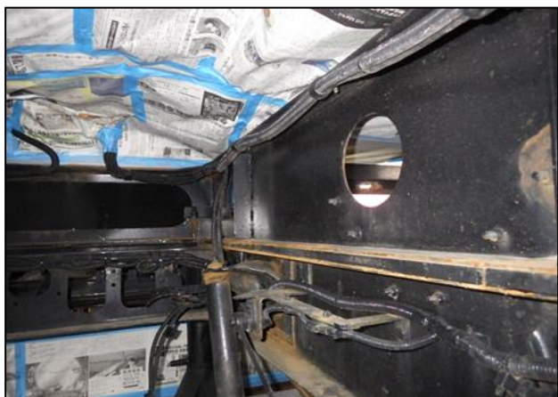
図-7 塗料B シャシフレーム内側状況
