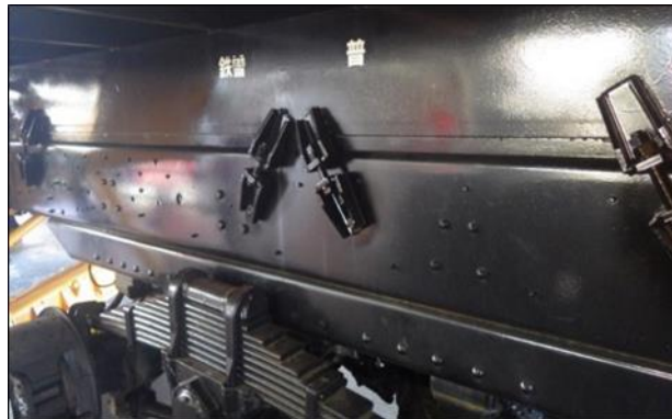
図-9 塗料B 除雪専用車シャシフレーム外側状況
