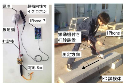
写真-7 AR 打音検査装置の構成 (左) と測定状況 (右)
